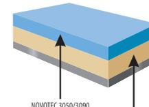
1. PROTECT 371 (Грунт Алкидный) – DFT 70 µm
