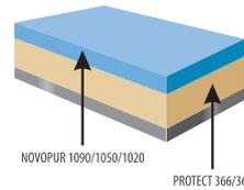
1. PROTECT 366/365 (Эпоксидный Грунт) – DFT 80 µm
