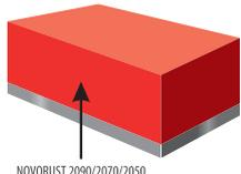
1. NOVORUST 2090/2070/2050 (Грунт Эмаль Полууретановая) – DFT 160 µm
