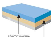
1. PROTECT 341 (Эпоксидный Реактивный Грунт) – DFT 50 µm
