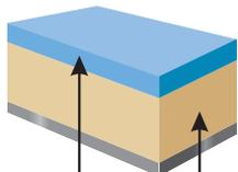
1. PROTECT 365 (Эпоксидный Грунт) – DFT 150 µm
