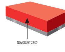
1. NOVORUST 2550 (Грунт Эмаль Алкидная) – DFT 100 µm
