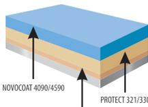
1. PROTECT 340 (Реактивный Грунт) – DFT 20 µm
