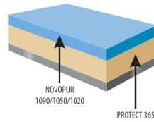
1. PROTECT 365 (Эпоксидный Грунт) – DFT 80 µm
