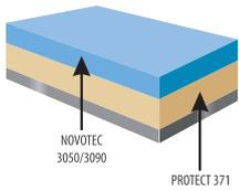
1. PROTECT 371 (Грунт Алкидный) – DFT 70 µm
