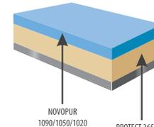
1. PROTECT 365/366 (Эпоксидный Грунт) – DFT 80 µm
