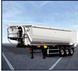
**Алюминий – самосвалный кузов грузового автомобиля**
